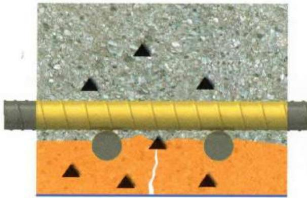
Καθαρισμός για την αφαίρεση τυχόν στοιχείων που επηρεάζουν τη διείσδυση του αναστολέα διάβρωσης (αλατώσεις, τσιμεντοειδερμίδα, βαφές, έλαια). Καθαρισμός της οροφής με σκούπισμα, βούρτσισμα, αναρρόφηση ή φύσημα με πεπιεσμένο αέρα χωρίς συμπιεστή λαδιού. Ήπια διαβροχή πριν την εφαρμογή Αντιδιαβρωτικού εμποτισμού στο σκυρόδεμα.
